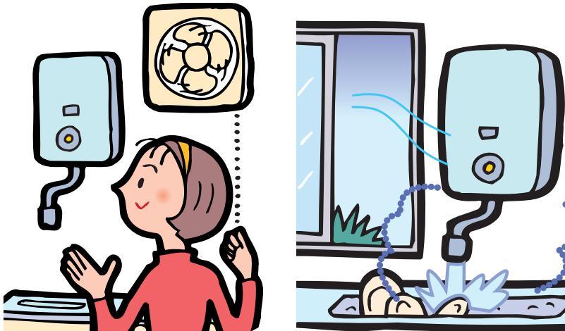
必ず換気扇をまわすか、窓を開けて換気をしてください。
