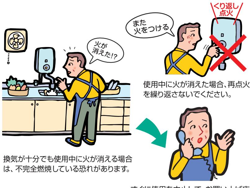
下記の現象が現れた場合は、継続して使用すると不完全燃焼による一酸化炭素中毒の恐れがあり、大変危険です。
