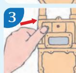
**復帰ボタンのキャップを手で左に回し、キャップを外してください。**
