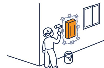
屋外に設置されたガス機器や屋内ガス機器の排気筒の先端を波板などで囲わないでください。空気が不足し、不完全燃焼の原因となるおそれがあります。
