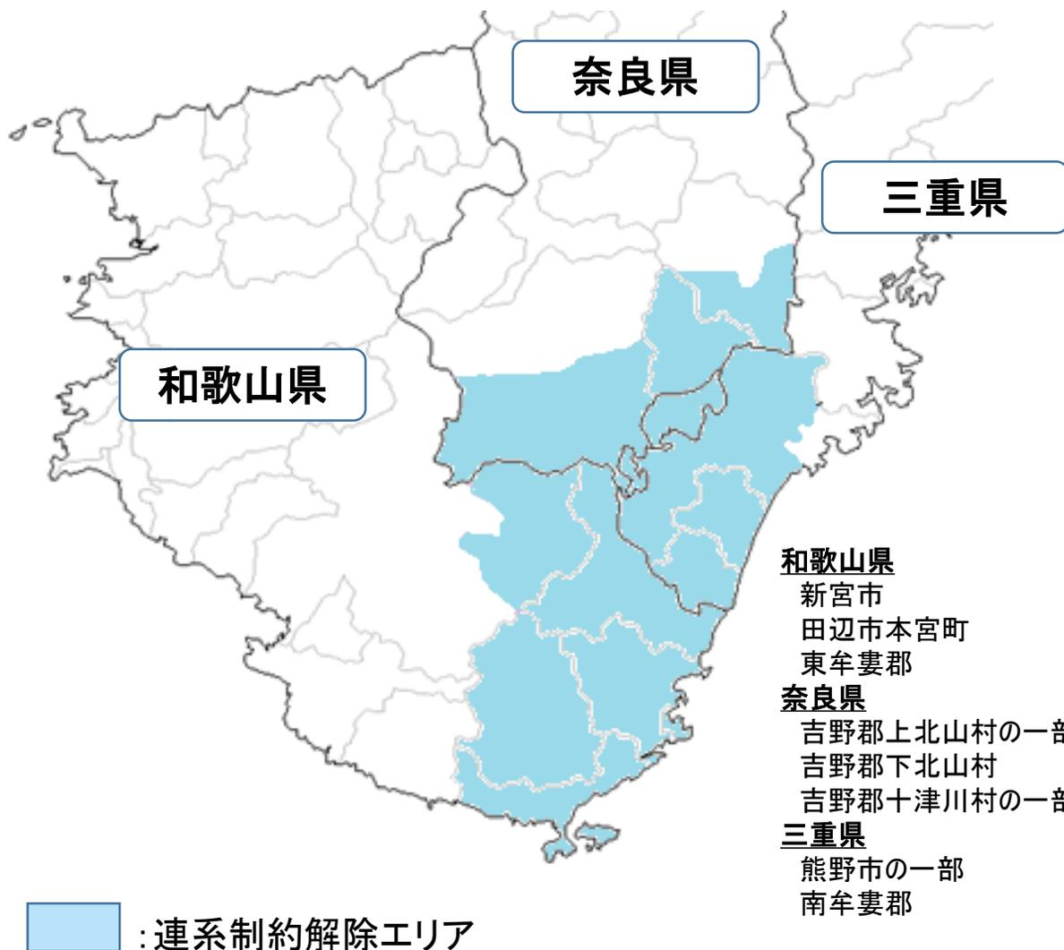
上記のエリアにつきましては、太陽光や風力など発電設備の種類を問わず、電力系統への逆潮流が発生する10kW以上の発電設備を連系していただくことができませんでしたが、対応策検討の結果、連系制約を解除出来る事となりました。
